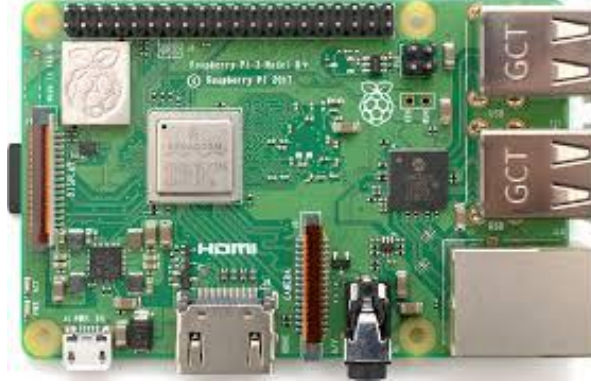
الشكل 1. مكونات لوحة راسبيري باي
