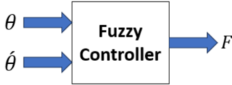
الشكل 9 . المتحكم الضبابي لموازنة النواس المقلوب
