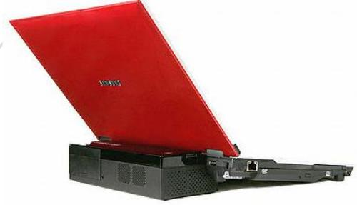
الشكل 2. خلية وقود من نوع DMFC مخصصة لأجهزة الكمبيوتر المحمولة من طراز Samsung PC Sens Q35 وتتيح ديمومة تبلغ حوالي 8 ساعات وبطاقة قصوى تبلغ 20 واط.
