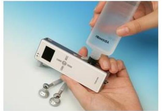
الشكل 3. جهاز Walkman يعاد شحنه بالميثانول و يستخدم خلايا الوقود من إنتاج شركة Toshiba حيث يتكون الوقود من 99.5٪ ميثانول مركز.
